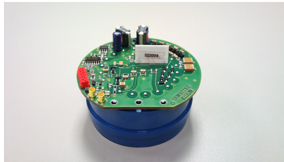
Abbildung 2.4: Die iseg-Basis: Das iseg-Board auf einem B20-Sockel, aus [Nac11].
