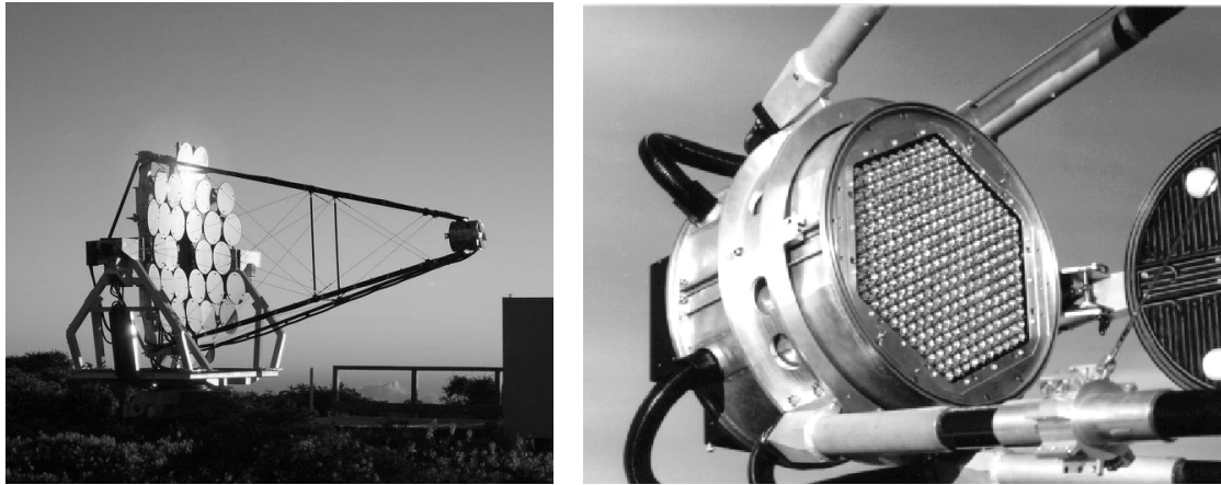
Abbildung 2.5: Links: Das HEGRA-Cherenkov-Teleskop CT2. Zu erkennen ist die Anordnung der Einzelspiegel im Davies-Cotton-Design, die PM-Kamera in der Fokalebene, sowie die Aufhängung in der Altitud- und Azimut-Achse. Im unteren, rechten Teil des Bildes ist die Hütte mit der Auslese- und Steuerungselektronik zu erkennen. Rechts: Die geöffnete Kamera, in der sich die 271 hexagonal angeordneten Photomultiplier befinden.
